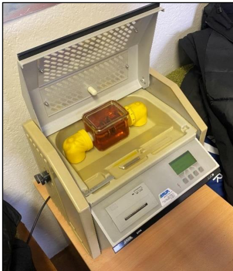
Přístroj pro měření transformátorového oleje
