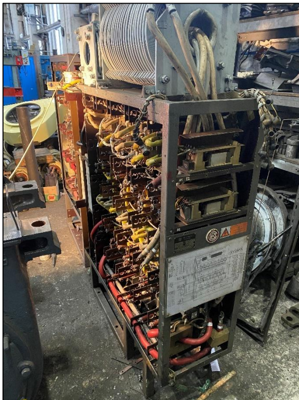
Pulsní měnič – lok. 363 – určený pro opravu
