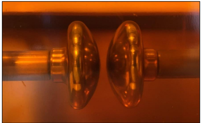
Kontakty v měřeném oleji (2,5 mm od sebe)
