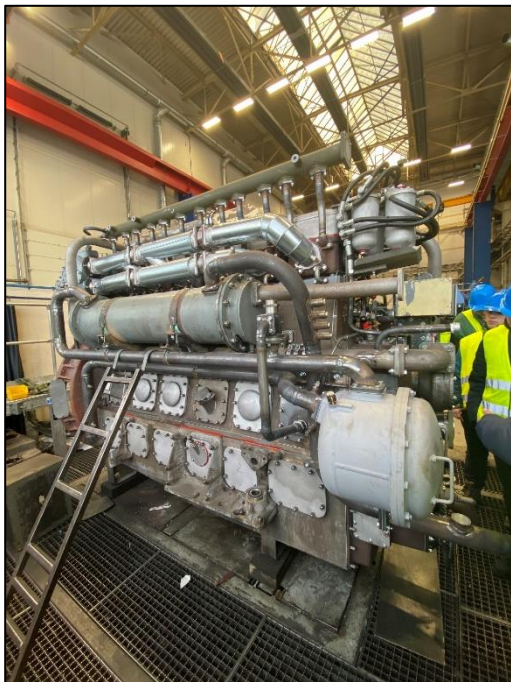
ČDK spalovací motor se sdruženou regulací výkonu
